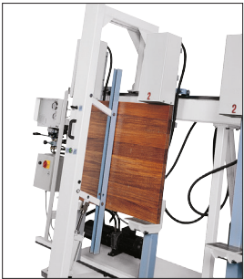
Detail pneumatickej prítlačnej svorky v prevádzke.
