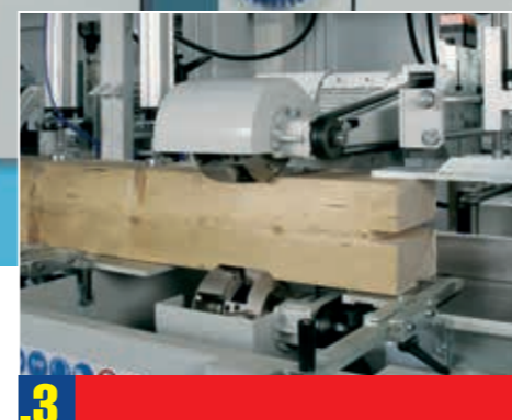
Horizontálne vrubovanie Horizontal notching unit Grupo de fresado horizontal Groupe de fraisage horizontal Узел формирования горизонтального паза для соединения бруса в замок
