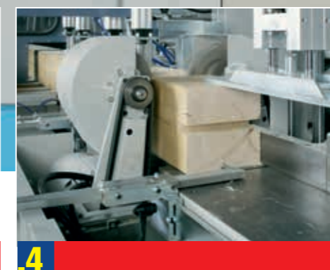
Vertikálne vrubovanie Vertical notching unit Grupo de fresado vertical Groupe de fraisage vertical Узел формирования вертикального паза для соединения бруса в замок
